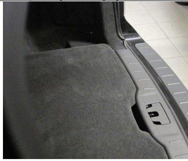
bild till vänster: Volvo V50 med bagagerumsgolv någon centimeter under tröskelpanel
